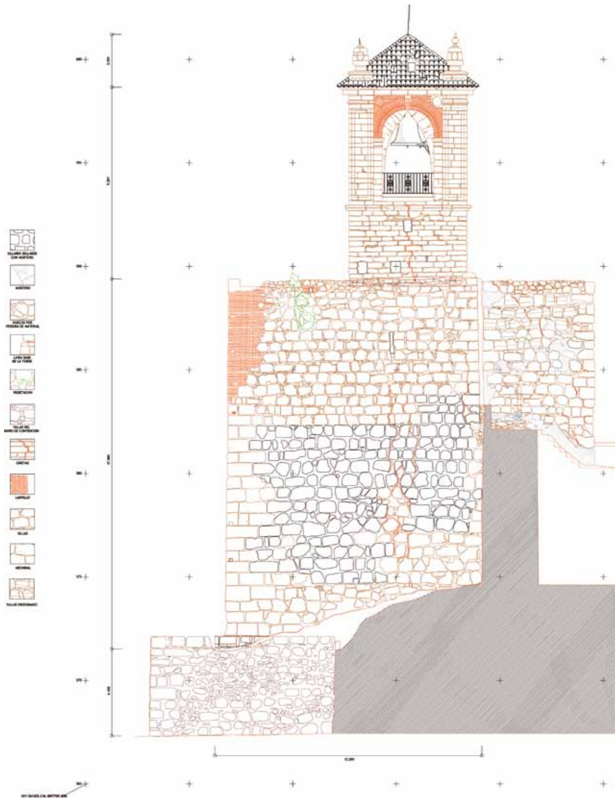
Alzado fotogramétrico del frente este de la Torre del Homenaje con representación de los materiales constructivos. Centro Municipal de Patrimonio Histórico.
