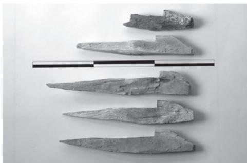
Lámina 8. Detalle de clavos de madera usados en la ejecución de tapias de hormigón militares en Juromenha (Portugal).
