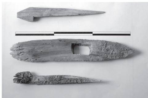
Lámina 9. Detalle de clavos y una aguja de madera usados en la ejecución de tapias de hormigón militares en Jorquera (Albacete).
